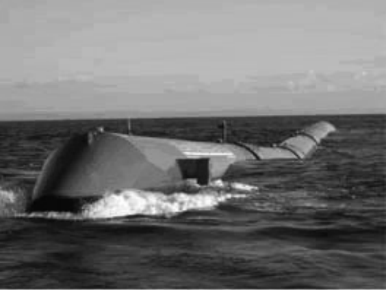
写真3 英国 Pelamis Wave Power 社が開発した波力発電装置 "Sea Snake"。2004年に英北部で最初の
