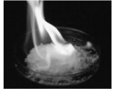
写真1 「燃える氷」人工メタンハイドレートの燃焼
