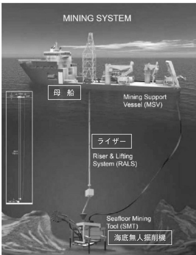
図一7 Technip社が提案する海底熱水鉱床の生産概念図：海底に掘削機を降ろし、掘り碎いた鉱石を海上の母船まで吸い上げる。日本でも同様の方法と考えられる。
