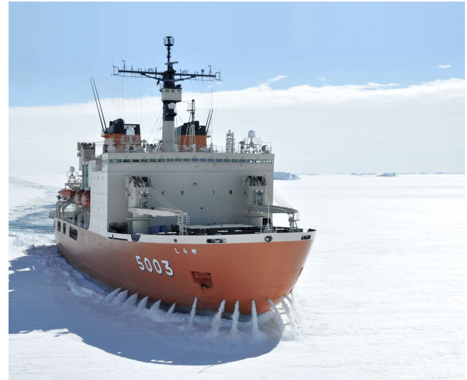
2代目しらせの砕氷補助用散水装置：船首部水面上にあるノズルから氷板へ散水し、積雪や海氷と船体との摩擦抵抗を低減する装置。
